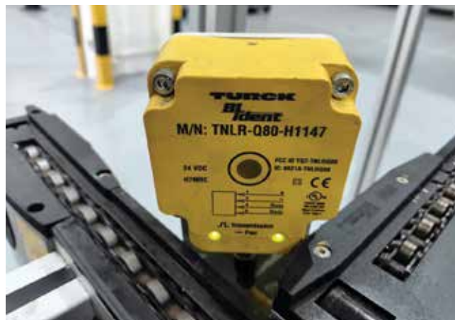
Odolná čítacia/zapisovacia hlava Turck Q80 HF umožňuje vďaka svojej veľkejmu rozsahu spoľahlivú detekciu RFID, aj keď sa poloha štítkov mení.
