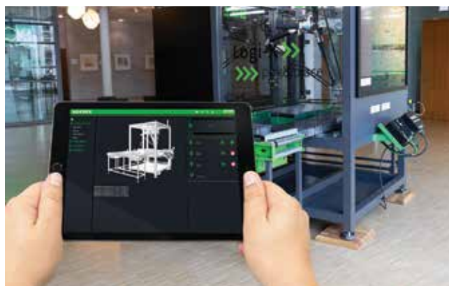
Digitálne dvojča umožňuje virtuálne otestovanie a optimalizáciu stroja alebo zariadenia už pred uvedením do prevádzky.
