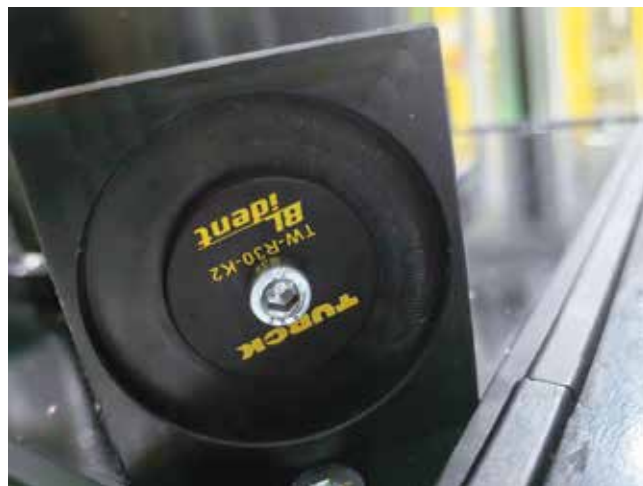
S 10 miliardami operácií zápisu zaručuje TW-R30-K2 dlhodobu veľmi dobrú čitateľnosť.
